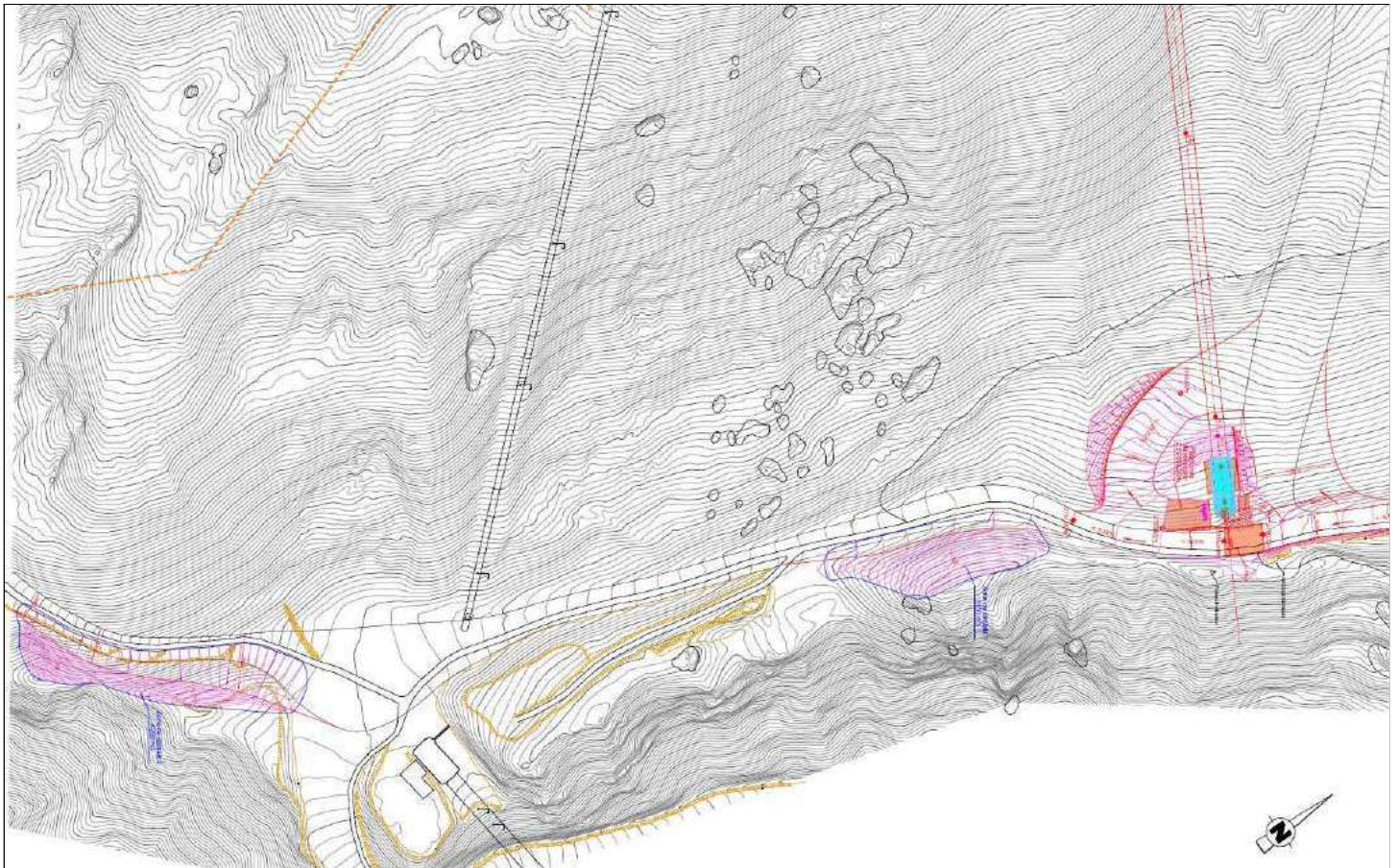
Zones de déblais à l'arrivée du TSD 6 des Cases
